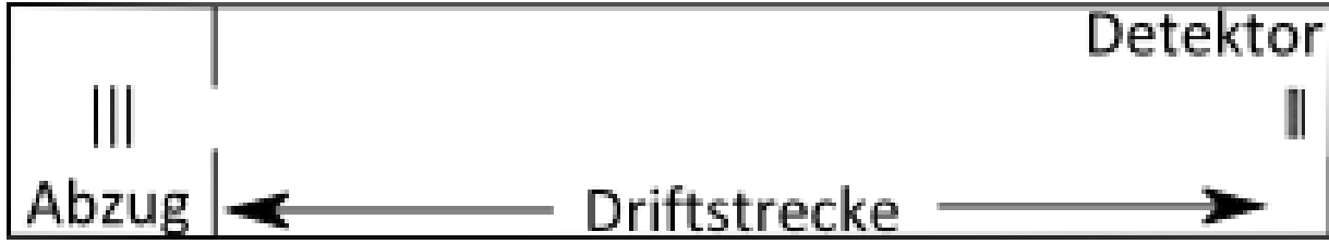
Abbildung 2.4: Das lineare TOF besteht aus einer Ionenquelle, aus einem feldfreien Flugrohr und einem Detektor. Die erzeugten Ionen werden im Abzug, hier bestehend aus drei Blenden, in die Driftstrecke beschleunigt und am Massendetektor detektiert.
